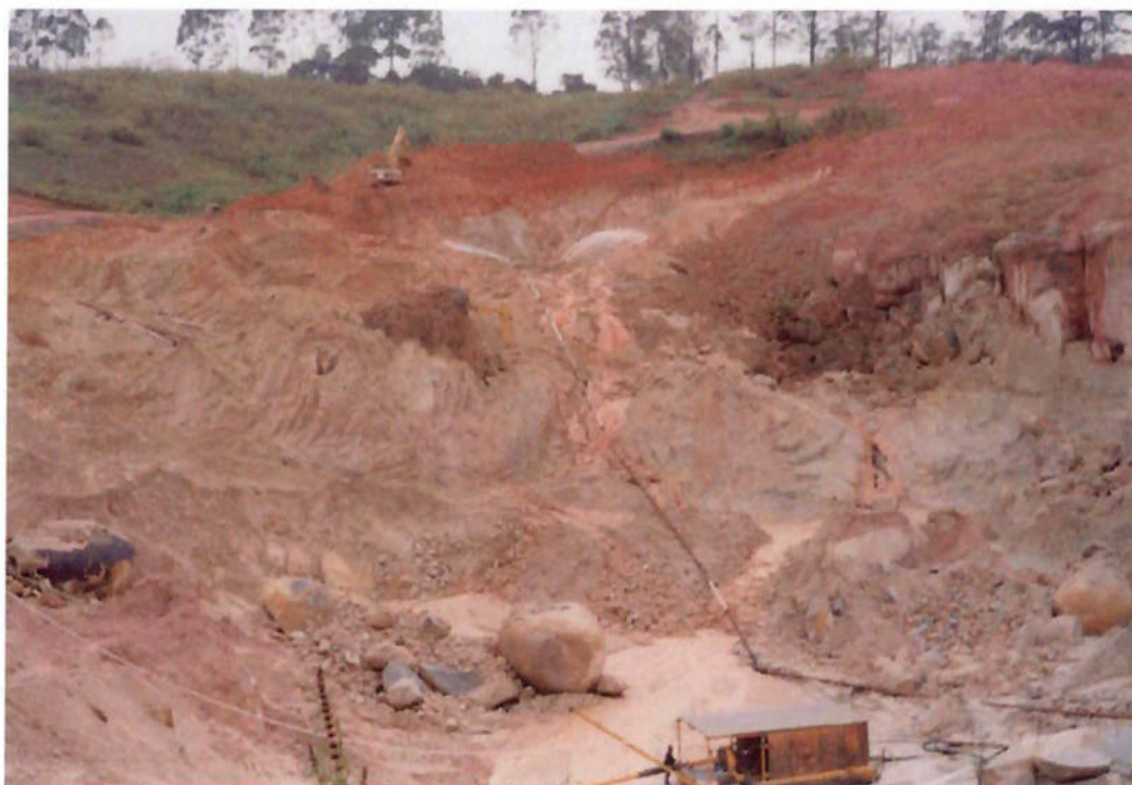
Figura 6.2 – desmonte hidráulico da Mineração Viterbo Machado Luz
